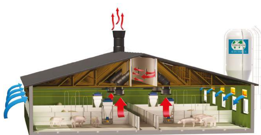
Wentylacja centralna Центральная вентиляция
