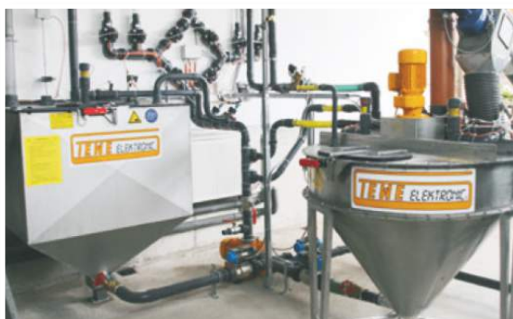
Karmienie bezresztkowe. Okrągły mieszalnik przemysłowy ze zbiornikiem na wodę użytkową.
